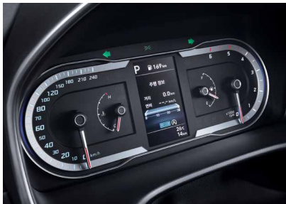
프로젝션 헤드램프 (바이평선) 클러스터 (4.2인치 컬러 LCD)
